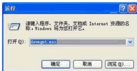
图 3-1： 输入“devmgmt.msc”打开设备管理器。
